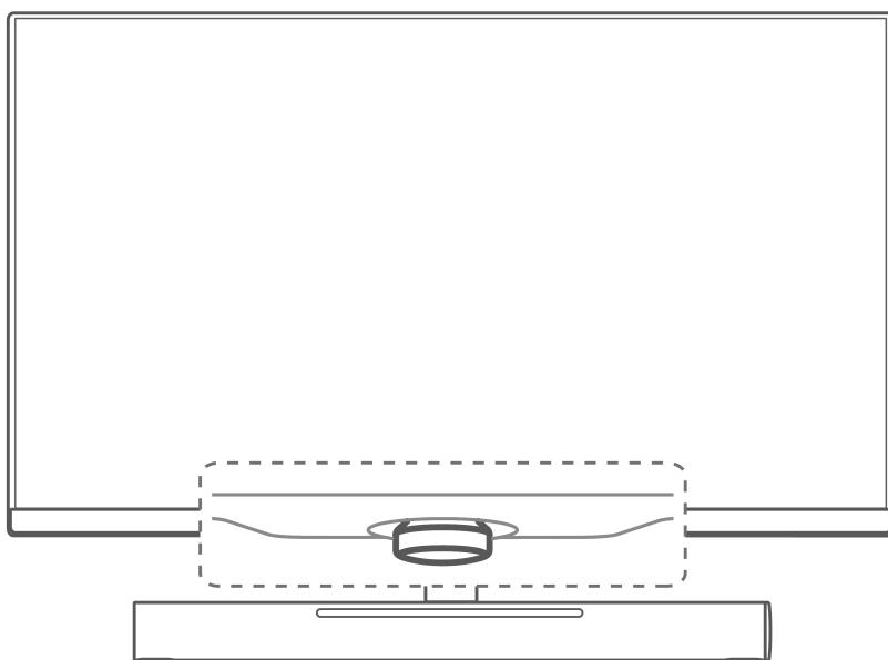
Функциональная кнопка монитора может быть использована для включения и выключения монитора, а также для настройки экранного меню.
