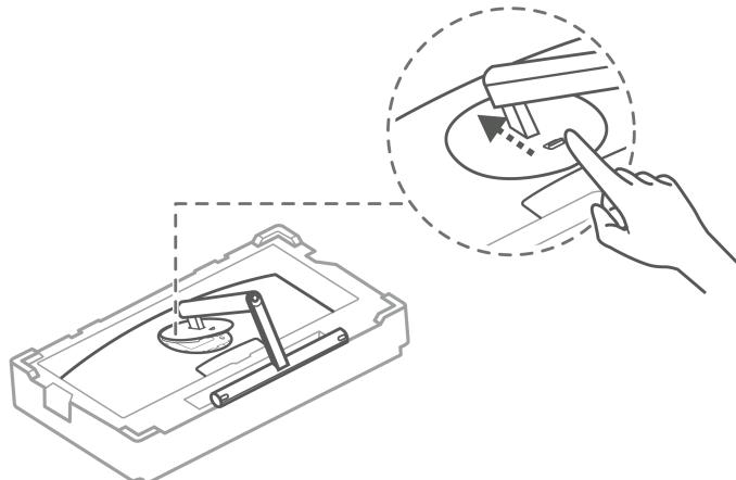
**⚠** Перед установкой подставки убедитесь, что к подставке в задней части монитора не прикреплены металлические предметы, в противном случае может произойти короткое замыкание.
