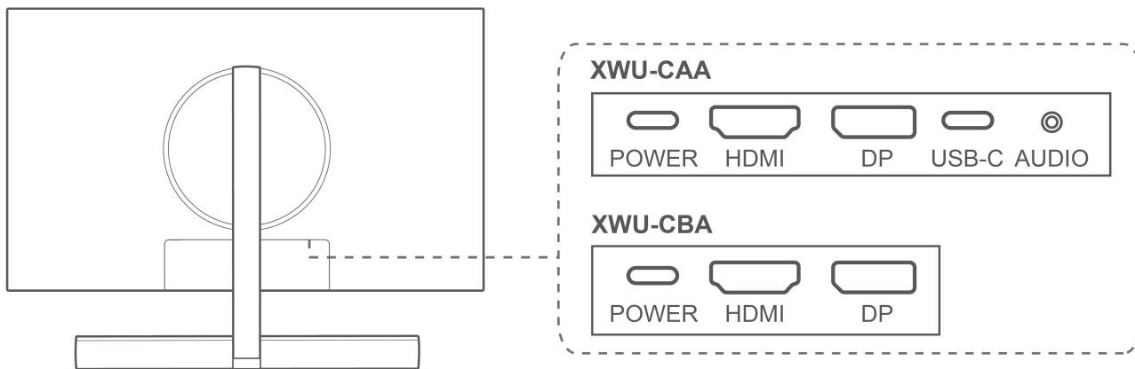
Откройте защитную крышку в нижней части задней панели монитора, чтобы увидеть порты. Монитор можно подключить к устройству, например компьютеру, в зависимости от типа кабеля.
