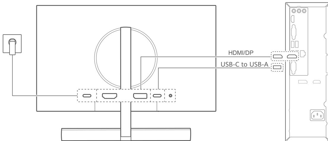
Подключение монитора к устройству, например компьютеру, для использования микрофона
