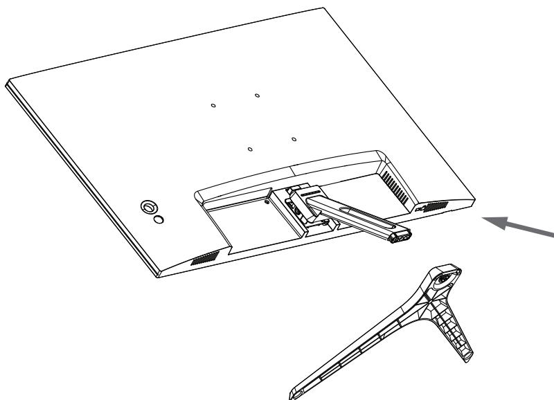
3. Установите собранный корпус подставки в пазы задней части монитора до характерного щелчка.
