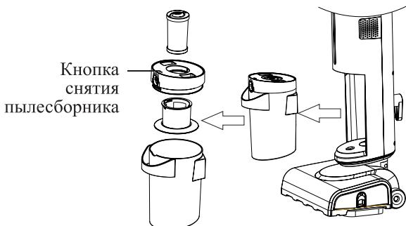
2. Поместите пылесборник над мусорным ведром. Извлеките фильтры, потянув блок фильтров вверх из контейнера пылесборника. Потяните на себя крышку пылесборника, вытащите фильтр тонкой очистки. Затем вытащите фильтр грубой очистки.
