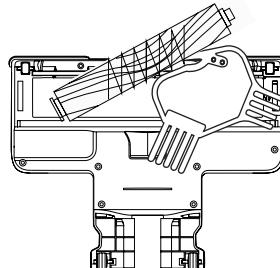
Присоедините турбощетку к щетке для пола или мини-щетке так, чтобы пазы на турбощетке совпали с выступом на щетке. Слегка надавите на другой конец турбощетки, затем сдвиньте фиксатор влево до щелчка, чтобы зафиксировать турбощетку.
