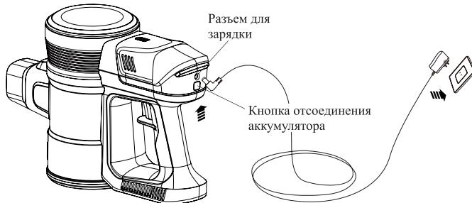
Индикатор заряда состоит из трех делений. При подключении к сети пылесоса с низким уровнем заряда начнет мигать одно деление. Когда аккумулятор полностью зарядится, все деления загорятся зеленым цветом.
