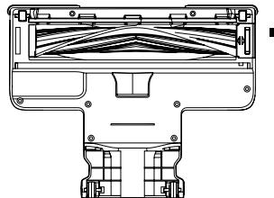
Очистите турбощетку от накрутившихся волос, ниток и пыли с помощью острого выступа на щеточке для очистки, как это показано на рисунке. При необходимости аккуратно срежьте их ножницами, не задев волокно самой турбощетки. Протрите щетку для пола или мини-щетку мягкой слегка влажной тканью.
