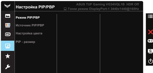
При включении данной функции на мониторе отображаются два, три или четыре изображения от различных источников видеосигнала.
