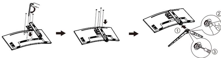
\*Размер винта для основания: М6 х 17 мм
