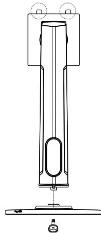
2. Положите монитор на ткань ЖК-панелью вниз, чтобы предотвратить повреждение ЖК-панели. Установите собранный корпус подставки в пазы задней части монитора до характерного щелчка.
