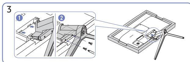
Постелите на стол мягкую ткань, а на нее экраном вниз положите устройство. Вставьте собранную подставку в корпус в направлении стрелки, как показано на рисунке. Полностью закрутите соединительный винт в нижней части корпуса.
