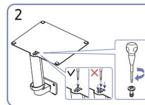
2 Полностью закрутите соединительный винт в нижней части подставки, чтобы как следует зафиксировать соединительный элемент. Затяните большой винт в середине, чтобы собрать конструкцию вместе.
