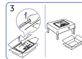
3 Извлеките устройство и пенопластовые вкладыши, а затем разместите устройство на столе лицевой стороной вниз, как показано на рисунке.
