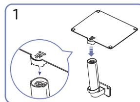
1 Поместите подставку в соединительный элемент, как показано на рисунке. Проверьте, надежно ли закреплен соединительный элемент подставки.
