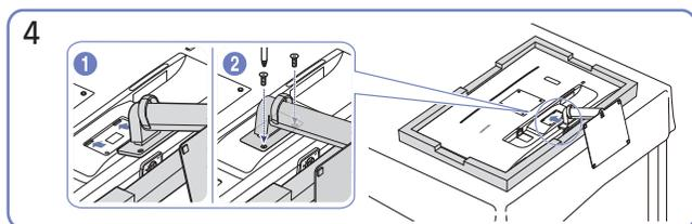
4 Вставьте собранную подставку в корпус в направлении стрелки, как показано на рисунке. Полностью закрутите соединительный винт в нижней части корпуса.
