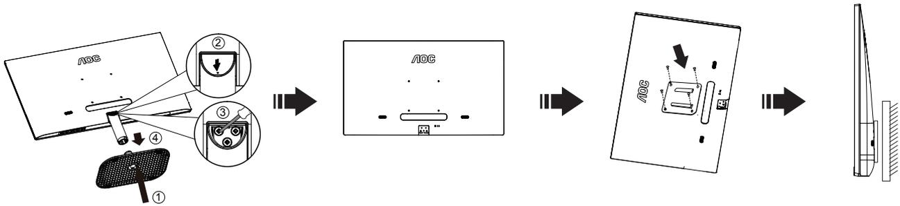
Монитор можно прикрепить к рычагу для крепления к стене, который приобретается отдельно. Отключите питание перед выполнением этой процедуры. Выполните следующие действия:
