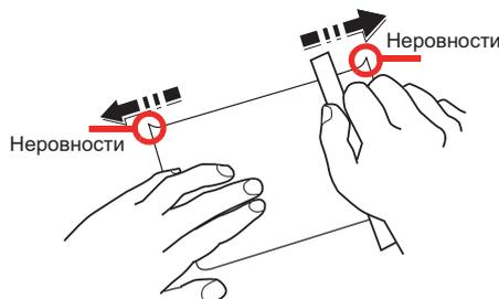
Перед загрузкой Наgакi (карточек) встряхните их и выровняйте кромки. Наgакi (карточкi) следует загружать в универсальный лоток стороной для печати вниз или в кассету и дополнительный податчик бумаги стороной для печати вверх. Если бумага Наgакi (карточкi) скручена, перед загрузкой ее следует распрямить. Печать на скрученной бумаге Наgакi (карточкi) может привести к замятию.
