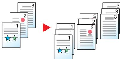
При использовании сдвига бумага каждого набора (или каждой страницы) при выводе поворачивается на 90°.
