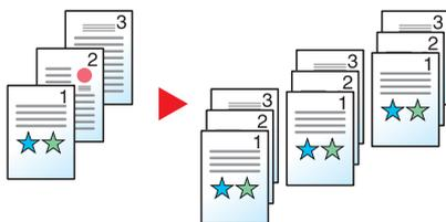
При использовании сдвига бумага каждого набора (или каждой страницы) при выводе сдвигается.
