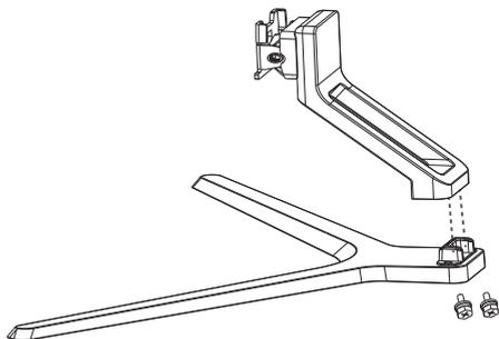
2. Положите монитор на ткань ЖК-панелью вниз, чтобы предотвратить повреждение ЖК-панели. Установите собранный корпус подставки в пазы задней части монитора до характерного щелчка.
