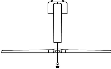
2. Положите монитор на ткань ЖК-панелью вниз, чтобы предотвратить повреждение ЖК-панели. Установите собранный корпус подставки в пазы монитора до характерного щелчка, как показано на рисунке ниже.
