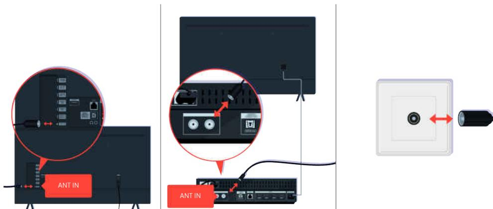
Проверьте подключение антенны и кабеля входного сигнала.
