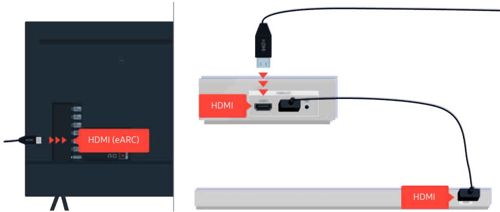
Если звуковая панель подключена к ресиверу, а ресивер подсоединен к телевизору с помощью кабеля HDMI, проверьте разъем HDMI с обратной стороны телевизора. Кабель должен быть подключен к порту HDMI (eARC) на телевизоре.
