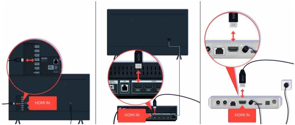
Проверьте подключение антенны и кабеля HDMI.
