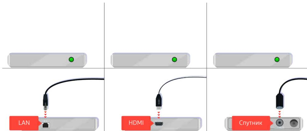
Если используется телеприставка, проверьте кабельное соединение. Кабель, который нужно проверить, зависит от типа приставки.
