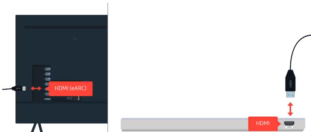
Если из звуковой панели нет звука и она подключена к телевизору с помощью кабеля HDMI, проверьте разъем HDMI (eARC) с обратной стороны телевизора.
