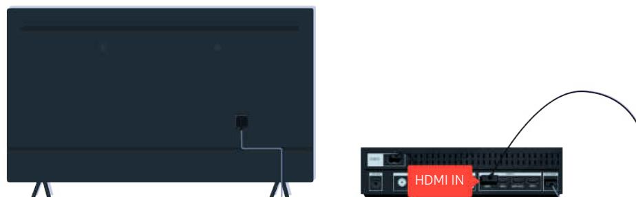
Чтобы повысить качество видеоизображения, используйте кабель HDMI (если внешнее устройство его поддерживает).
