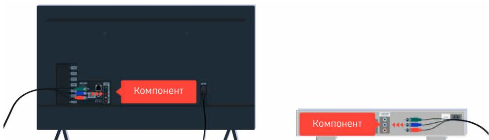
Если используется компонентный кабель, убедитесь, что цветные коннекторы подключены к разъемом соответствующих цветов на внешнем устройстве и телевизоре.
