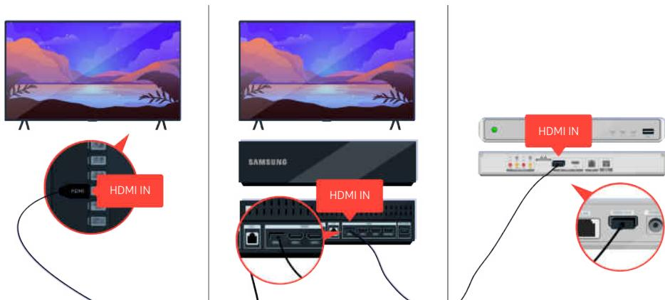
Если проблема не исчезает, попробуйте подключить к телевизору другое устройство с помощью кабеля HDMI.
