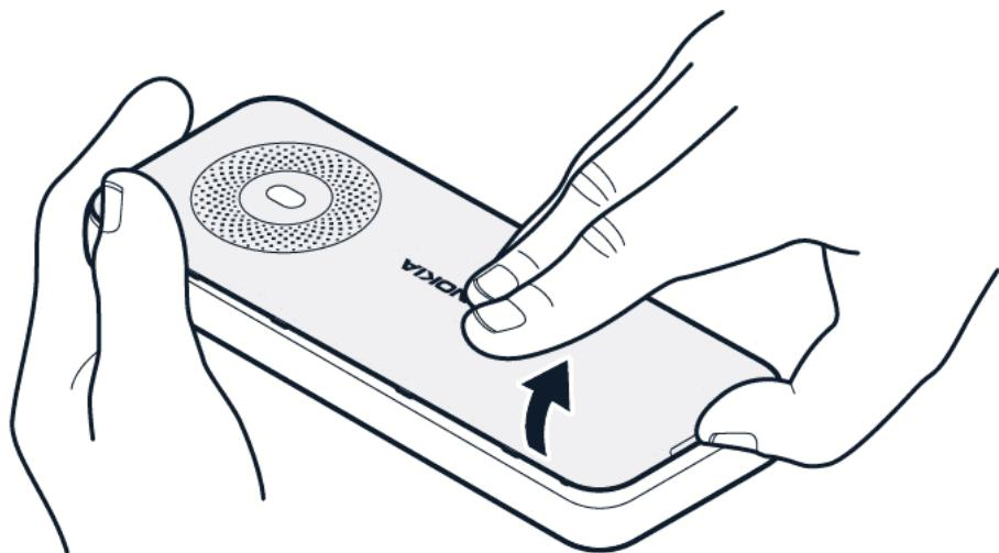
1. Вставьте ноготь в небольшой разъем в нижней части телефона, поднимите и снимите крышку.
