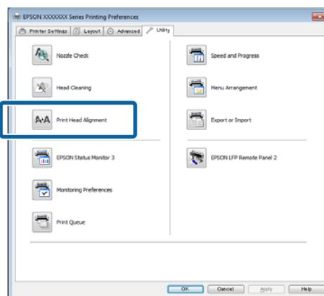
Датчик считывает калибровочный шаблон во время печати и автоматически регистрирует оптимальное значение калибровки на принтере.
