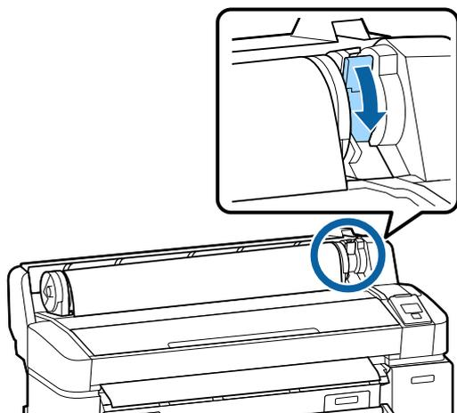
Если параметр **Автоматич. загрузка** установлен в значение **Выкл.** на SC-T7200 Series/SC-T5200 Series/SC-T3200 Series или SC-T7200D Series/SC-T5200D Series, можно обрезать край рулонной бумаги с помощью встроенного резака, нажав кнопку ОК, а затем кнопку
