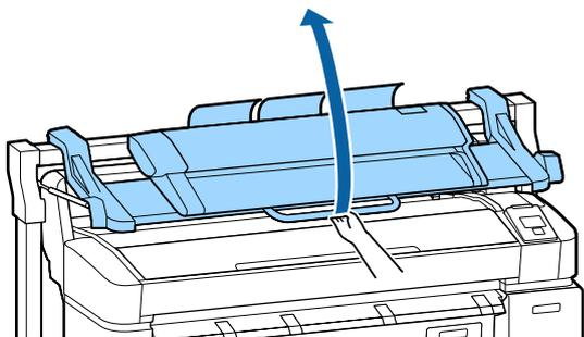
На устройствах SC-T7200D Series/SC-T5200D Series способы загрузки рулонной бумаги в рулонные устройства 1 и 2 различаются. После прикрепления адаптера рулонной бумаги см. следующие разделы.
