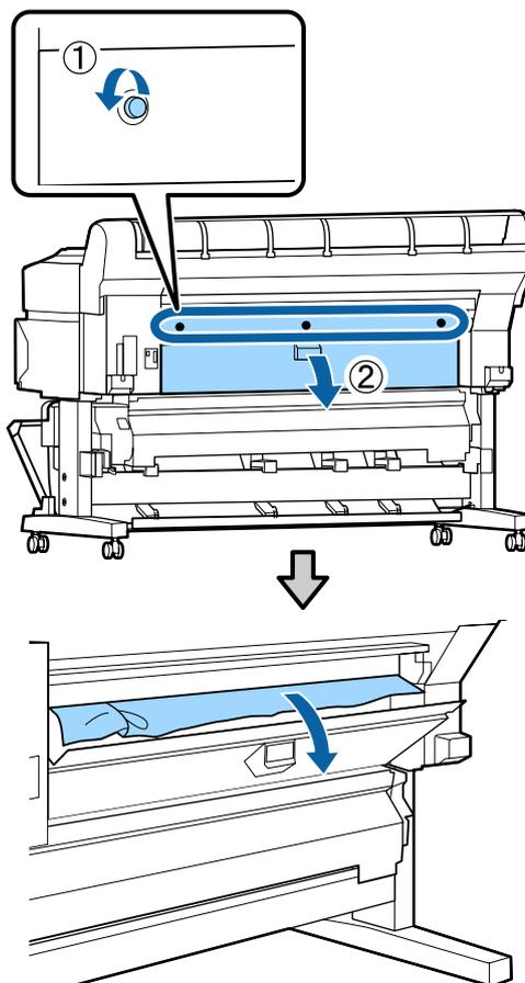
(3) Откройте заднюю крышку и затем затяните
