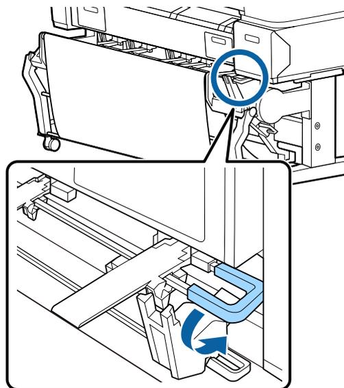
Как показано на следующих иллюстрациях, отрегулируйте положение направляющей стопки в соответствии с размером бумаги.
