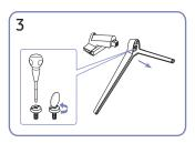
Извлеките соединительный элемент из подставки, потянув его в направлении стрелки, как показано на рисунке.
