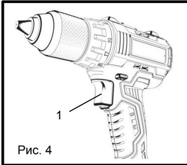
Для того чтобы включить инструмент, нажмите на выключатель (1; рис.4).
