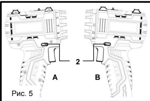
Реверсивный переключатель направления вращения (2; рис.5) позволяет установить направление вращения патрона, а также служит для блокировки случайного пуска инструмента.
