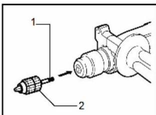
Чтобы можно было работать с инструментами без хвостовика типа „SDS-plus” (напр., для работы сверлами с цилиндрическим хвостовиком), необходимо установить сверлильный патрон кулачкового типа, снабженный хвостовиком типа „SDS-plus” или при использовании специального адаптера.
