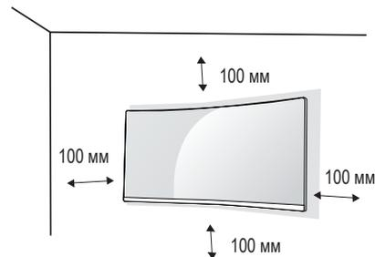
Чтобы установить монитор на стену, прикрепите кронштейн для настенного крепления (дополнительная деталь) к задней части монитора.
