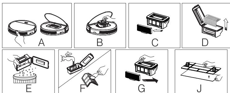
**Примечание:** рекомендуется очищать пылесборник и всасывающий канал после каждого использования и очищать фильтры 1-2 раза в месяц.
