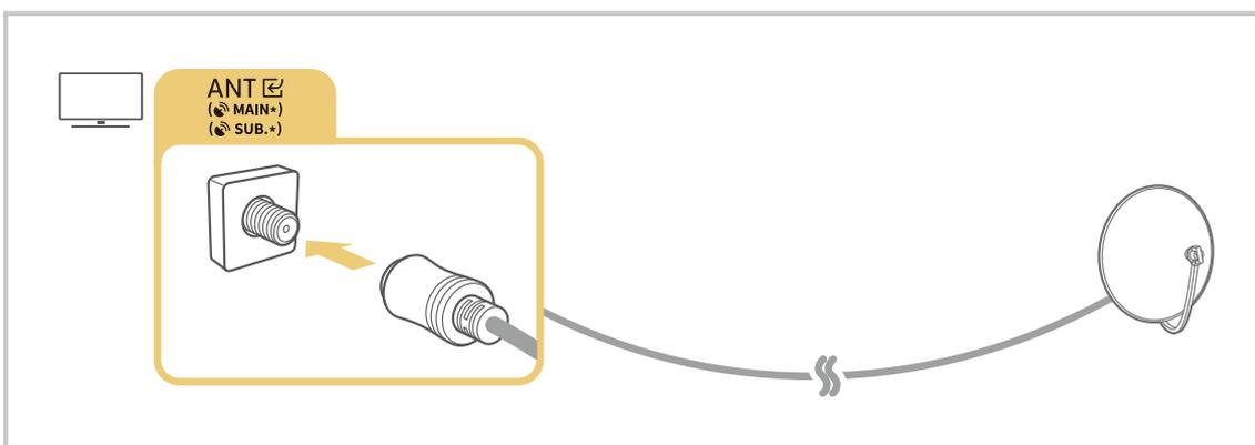
Рекомендуется подсоединить оба разъема с помощью Multi-Switch или DiSEqC, после чего установить **Тип подключения антенны** в режим **Двойная**.
