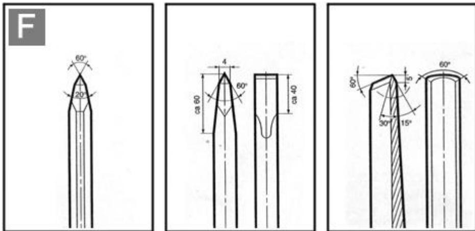
Только при помощи заточенных (острых) долот можно добиться хороших результатов работы, поэтому требуется заблаговременно заточить долота. Это обеспечивает большой срок службы рабочей оснастки и нормальную производительность работы.
