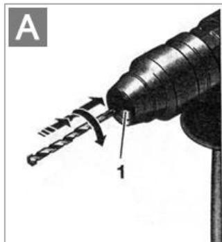
Инструмент автоматически фиксируется. Проверить фиксацию инструмента попыткой извлечь его из патрона для приёма инструмента.
