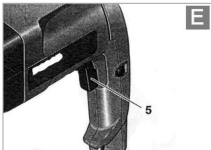
При работе прибора возможно плавное регулирование скорости вращения путём усиления/ослабления силы нажатия на выключатель 5.
