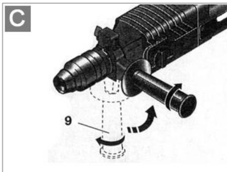
После установки положения дополнительной рукоятки 9 требуется её снова затянуть.
