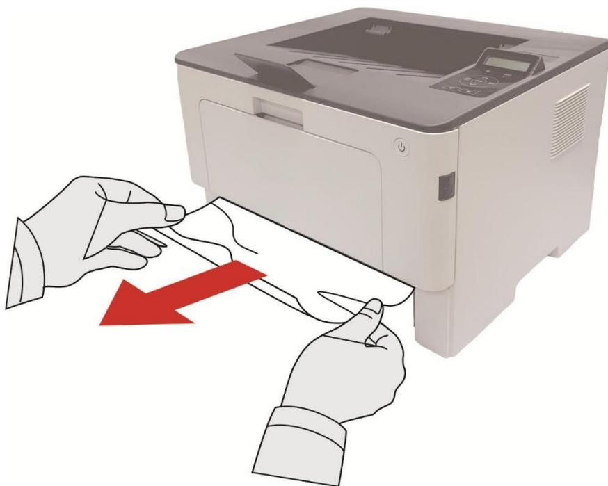
3. После удаления замятия бумаги повторно вставьте автоматический лоток в принтер; нажимайте кнопку на передней крышке, чтобы открывать и закрывать переднюю крышку, принтер возобновит печать автоматически.
