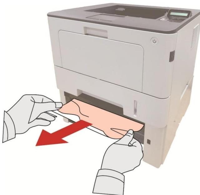
3. После извлечения замятой бумаги повторно вставьте дополнительный лоток в принтер, и принтер возобновит печать автоматически.
