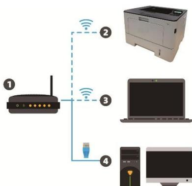
Инфраструктурная модель: соединяется с беспроводным оборудованием с помощью маршрутизатора
