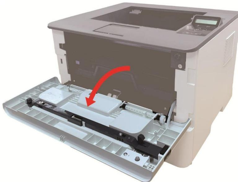
5. Вынимайте лазерные картриджи вдоль направляющего рельса. (уберите лазерные картриджи в лоток или пакет для предотвращения попадания на фотобарабан прямых солнечных лучей.)
