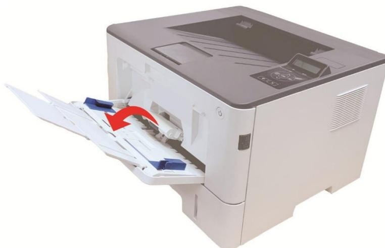
2. Выдвиньте направляющую бумаги многофункционального лотка подачи бумаги таким образом, чтобы она соответствовала обеим сторонам листа бумаги. Не применяйте чрезмерное усилие, в противном случае может возникнуть замятие или перекос бумаги.
