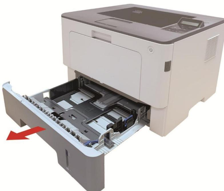
2. Сдвигайте удлинитель лотка автоматической подачи бумаги, регулятор длины и регулятор ширины листа до нужного размера бумаги, чтобы лоток сочетался с длиной и шириной бумаги.
