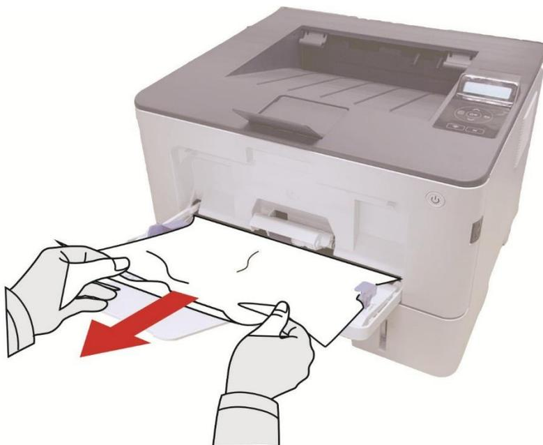
2. После удаления замятия бумаги повторно загрузите бумагу в многоцелевой лоток; нажимайте кнопку на передней крышке, чтобы открывать и закрывать переднюю крышку, принтер возобновит печать автоматически.
