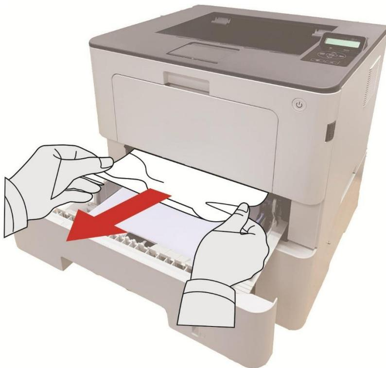
3. После извлечения замятой бумаги повторно вставьте автоматический лоток в принтер, и принтер возобновит печать автоматически.
