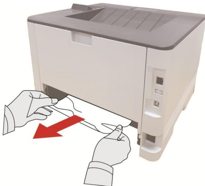
4. После извлечения бумаги, вложи двухсторонний элемент печати, просмотри другие части продукции, убедитесь в отсутствии бумаги, открывай и закрывай переднюю крышку, принтер восстанавливается печать автоматически.
