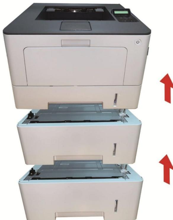
После извлечения дополнительного лотка необходимо повторно обновить состояние принтера (сведения о том, как обновить состояние принтера см. в разделе [«Обновление состояния дополнительного лотка»](#)).
