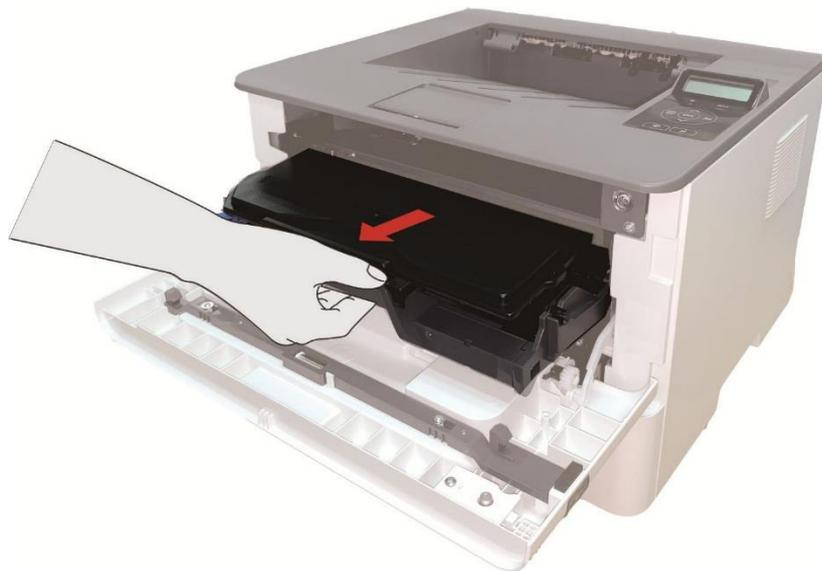
**Примечание:** • Вынув тонер-картридж, положите его в защитный пакет или оберните плотной бумагой, чтобы предотвратить его повреждение в результате попадания прямого солнечных лучей.
