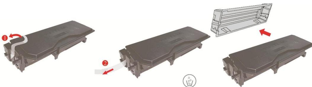
6. Вложи картриджи в блок барабана вдоль направляющего рельса внутри блока барабана, монтаж картриджи совершен.
