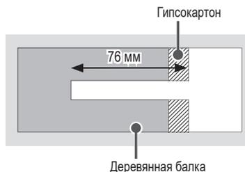
Используйте сверло Ø 4 мм для сверления отверстий глубиной 76 мм в деревянной балке. (Очистите просверленное отверстие.)
