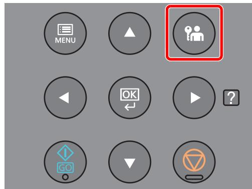
Нажмите клавишу [**Выход из системы**] для выхода из экрана меню параметров и выхода из системы. Аппарат вернется к обычному экрану.
