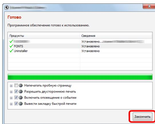
Когда появится сообщение "**Программное обеспечение готово к использованию**", можно начинать использование программного обеспечения. Для печати тестовой страницы установите флажок "**Напечатать пробную страницу**" и выберите аппарат.
