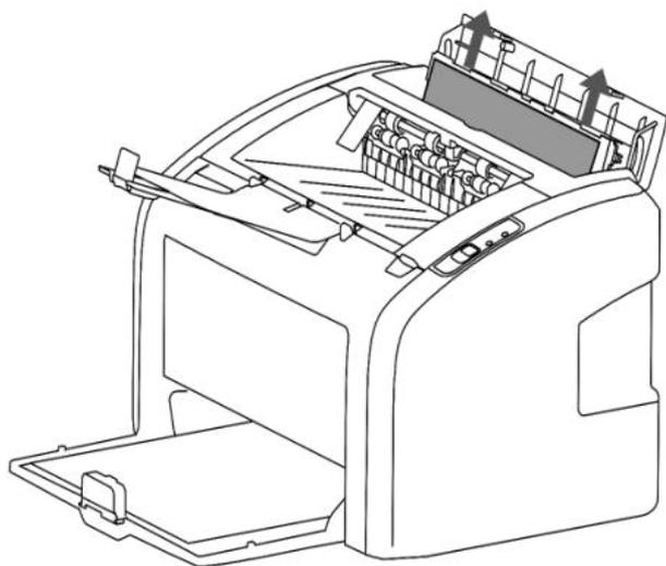
4. После устранения замятия бумаги закройте верхнюю направляющую панель, а затем крышку термоблока;
