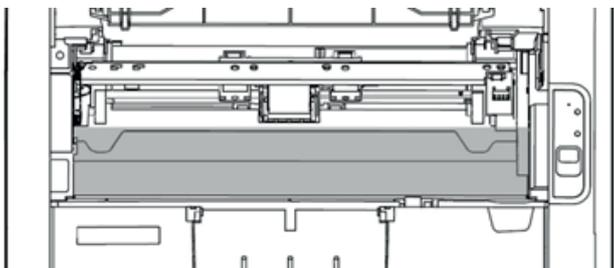
3. Вставьте на место картридж и затем последовательно закройте верхнюю крышку и переднюю крышку.
