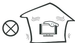
Устанавливайте телевизор в соответствии с инструкциями изготовителя. При установке телевизора обеспечьте свободное пространство вокруг него не менее 10 см с каждой стороны.
