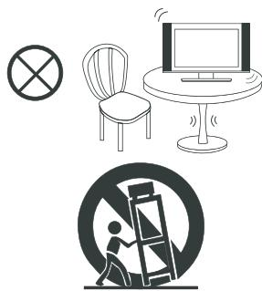
Используйте только рекомендованные производителем: тележку, подставку, треногу, кронштейн или стол. Когда используется тележка, будьте аккуратны при перемещении тележки совместно с телевизором, чтобы избежать его опрокидывания. Неожиданные остановки, чрезмерные усилия и неровности поверхности пола могут привести к падению телевизора с тележки и негативным последствиям.
