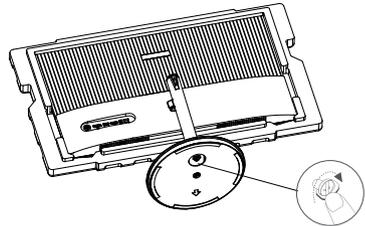
4. Соедините основание со стойкой с помощью винта-самореза.
