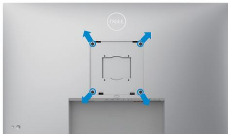
**ПРИМЕЧАНИЕ:** Для крепления монитора к комплекту для настенного монтажа используйте винты М6 x 35 мм (200 x 200 мм) или М4 x 12 мм (100 x 100 мм).
