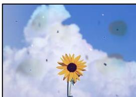
**На оригиналах или стекле сканера присутствует пыль или грязь.**
