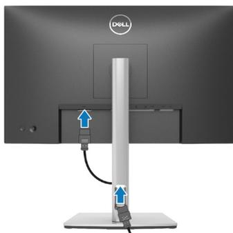
3. С помощью кабеля DisplayPort HDMI, USB-C (C-C) или USB-C (C-A) подключите монитор к компьютеру.
