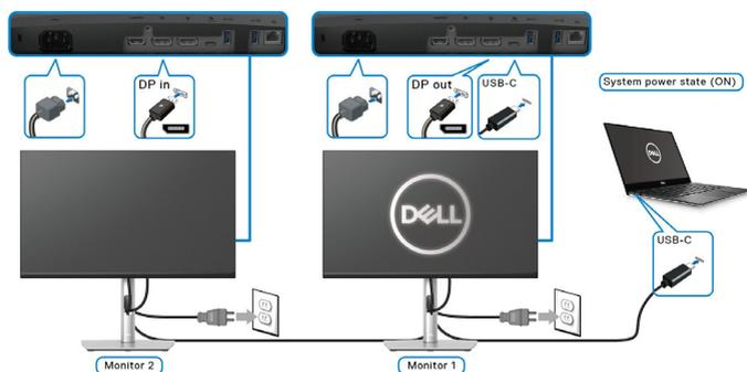
Аналогично, ПК подключен к двум мониторам и изначально его питание включено, состояние питания системы ПК синхронизировано с кнопкой питания монитора 1. При нажатии кнопки питания монитора 1 или ПК выключаются монитор 1 и ПК. При этом монитор 2 остается в режиме ожидания. Для выключения монитора 2 необходимо нажать его кнопку питания вручную.
