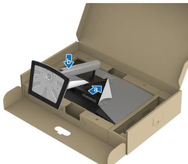
8. Удерживая стойку подставки, осторожно поднимите монитор, затем положите его на ровную поверхность.
