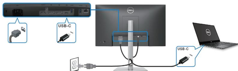
**ПРИМЕЧАНИЕ.** Используйте кабель USB-C (C-C), поставляемый в комплекте с монитором.
