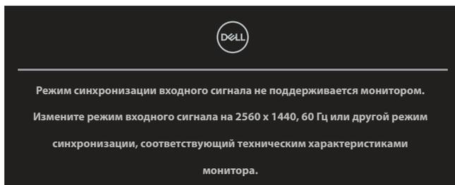
Это означает, что монитор не может произвести синхронизацию с получаемым от компьютера сигналом. Доступные для данного монитора диапазоны частот горизонтальной и вертикальной разверток представлены в разделе «Технические характеристики монитора».
