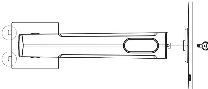
2. Положите монитор на ткань ЖК-панелью вниз, чтобы предотвратить повреждение ЖК-панели. Установите собранный корпус подставки в пазы задней части монитора до характерного щелчка.
