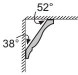
Если Вы хотите обрабатывать потолочные рейки, плоско положив их на стол пилы, Вам нужно установить стандартный угол распила 31,6° (горизонтальный) или 33,9° (вертикальный). Следующая таблица содержит указания для обработки потолочных реек.
