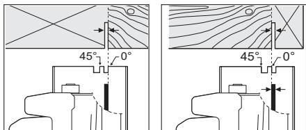
Метка линии распила 0° показывает положение пильного диска при распиливании под прямым углом. Метка линии распила 45° показывает положение пильного диска при распиливании под углом 45°.
