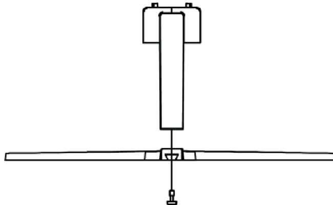
2. Положите монитор на ткань ЖК-панелью вниз, чтобы предотвратить повреждение ЖК-панели. Установите собранный корпус подставки в пазы задней части монитора до характерного щелчка, как показано на рисунке ниже.
