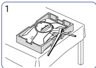
Положите на пол защитный пенопластовый материал (стирофом), входящий в комплект, и разместите на нем устройство экраном вниз, как показано на рисунке. При отсутствии защитного материала используйте толстый коврик.
