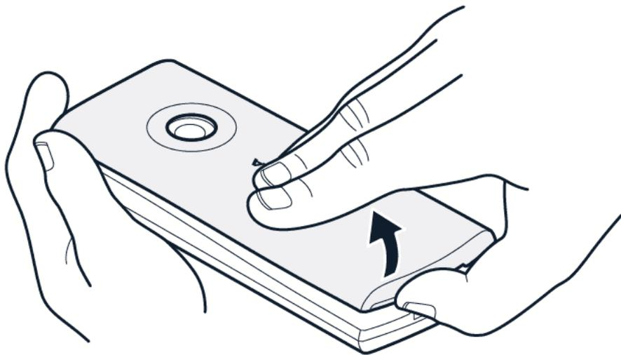
1. Вставьте ноготь в небольшой разъем в нижней части телефона, поднимите и снимите крышку.
