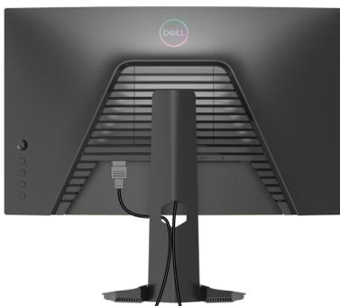
Подключив все необходимые кабели к монитору и компьютеру (порядок подключения кабелей см. в разделе [Подключение монитора](#)), пропустите все кабели через отверстие, как показано выше.
