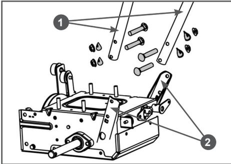
**Рис. 3 Установка рукояток ST553**
