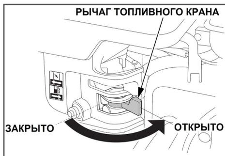
Рис. 22 Рычаг топливного крана
