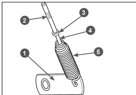
**Рис. 9 Регулировка длины тросов включения хода и шнека**
