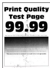
Печать покрыта пятнами и точками
