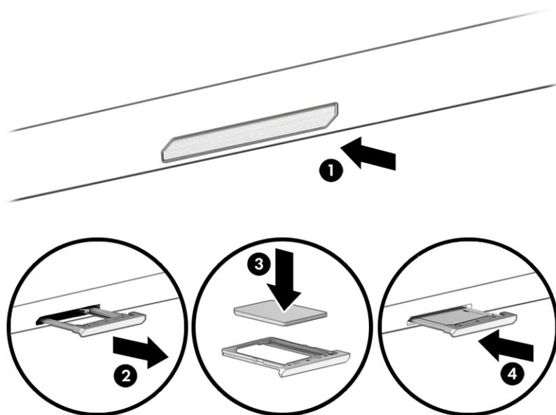
Чтобы извлечь SIM-карту, аккуратно нажмите на лоток для SIM-карты, чтобы разблокировать его. Лоток выдвинется из гнезда. Извлеките SIM-карту. Установите лоток на место и аккуратно надавите на него, чтобы зафиксировать.
