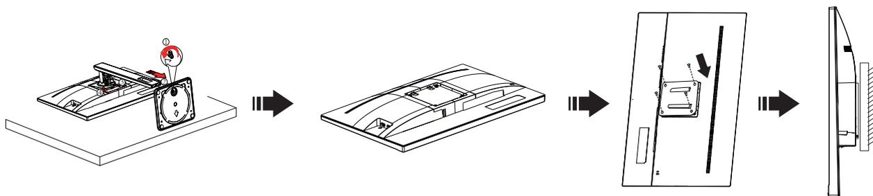
Монитор можно прикрепить к рычагу для крепления к стене, который приобретается отдельно. Отключите питание перед выполнением этой процедуры. Выполните следующие действия:
