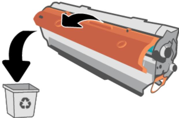
**⚠ ПРЕДУПРЕЖДЕНИЕ.** Чтобы не повредить картридж, держите его за края. Не касайтесь поверхности ролика.
