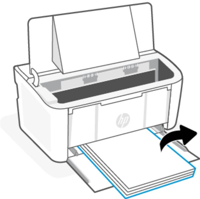
3. Возьмитесь двумя руками за наиболее выступающий край замятого материала (в том числе можно за середину) и аккуратно вытяните его из устройства.
